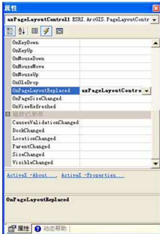
3. 在 axPageLayoutControl1\_OnPageLayoutReplaced 事件中键入以下向 MapControl 加载样例图形文档的代码。当文档被装载入 PageLayoutControl 时 OnPageLayoutReplaced 事件将会被触发。
